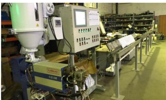
Резидент технопарка Мосгормаш ООО «ВНИИКП - Маш» изготовил экструзивную универсальную технологическую линию для производства проводов для АО «ОКБ КП», входящего в состав корпорации «Ростех». Проект проходил в рамках реализации инвестиционной программы Московского областного Правительства.
