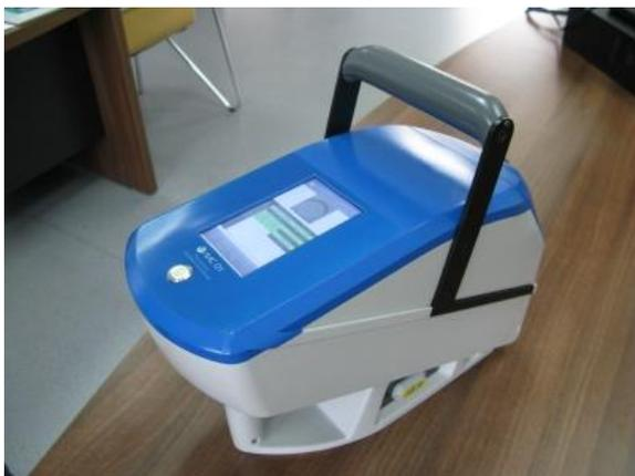
В идее разработки – создание портативного спектрометра, позволяющего мгновенно проводить химический анализ металлов.
