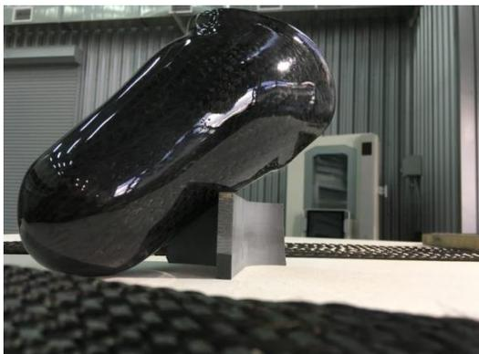
Культеприемная гильза из карбонового рукава компании Artek Braiding (входит в группу компаний «ТехноСпарк»), изготовленная по индивидуальным меркам, тестируется для регулярного применения. Заказчик гильзы — стартап «3Д Технолоджи» из Томска. Компания занимается изготовлением индивидуальных гильз методами 3D-технологий.
