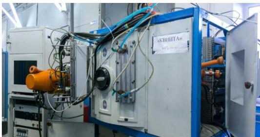
Ученые томского Института сильноточной электроники (ИСЭ СО РАН) и компании «Пучково-плазменные технологии» собрали установку, которая может очистить поверхность металла, упрочнить ее и задать новые нужные свойства за один технологический цикл.
