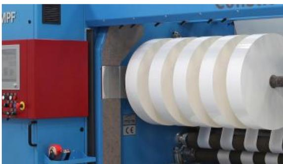
Поставщиком машин для резки рулонов биаксиально-ориентированных полиэтилентерефталатных (БОПЭТ) пленок выступит немецкая компания Kampf Schneid- und Wickeltechnik GmbH. Контракт предполагает поставку 5 единиц техники, предназначенной для продольной резки рулонов БОПЭТ-пленки на заданную ширину и диаметр, а также обрезки маскирующих краев рулонов, полученных в процессе металлизации.
