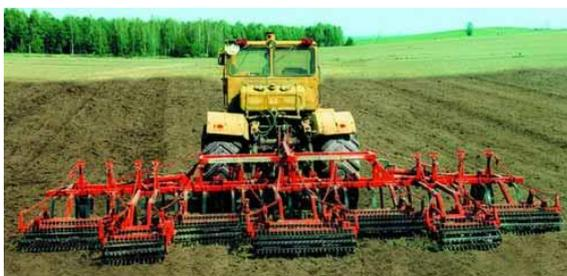
Предприятие «АНИТИМ», входящее в состав Алтайского кластера аграрного машиностроения «АлтаКАМ» и объединение «Алмаз», выпустило секционный универсальный культиватор «АЛТАЙ» с шириной захвата 11 метров. Данное орудие, не имеющее аналогов, производимых в Алтайском крае, предназначено для ранней предпосевной
